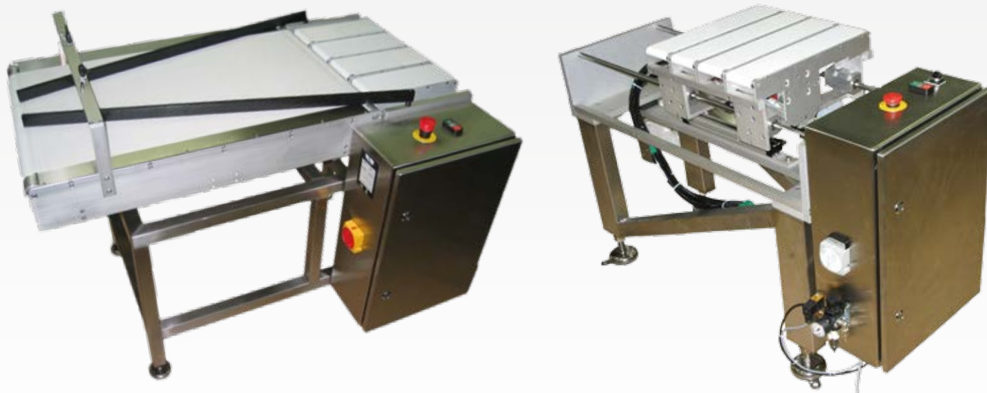
Tapis alignement produit pour combinaison 4 en 1 avant trieuse
